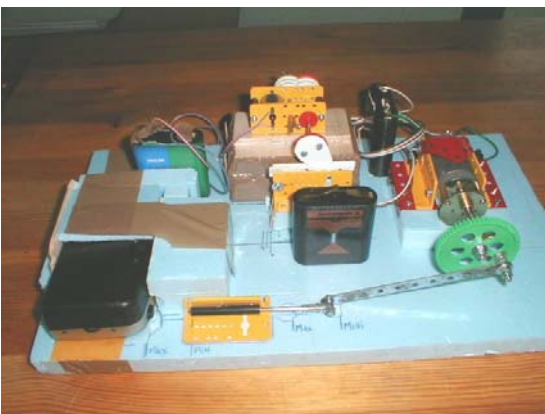
Système de déclenchement automatique d'un appareil photo
